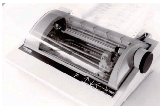
1981年米沢製作所が最初に開発した カラーペンプロッター
